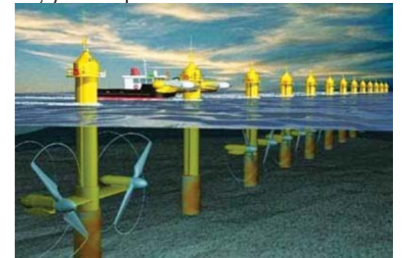
Gambar : Pembangkit listrik tenaga gelombang dan arus laut (PLTL), yang dibangun pada beberapa daerah yang memiliki potensi untuk pembangkit listrik. gelombang laut
