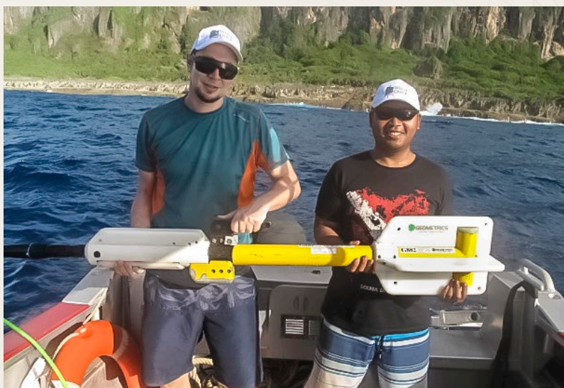
Tim gabungan arkeolog maritim dari Australia, Belanda, Dan Indonesia menggunakan alat survei magnetometer di Perairan Pulau Natal (Sumber: Wreck Check Inc)
