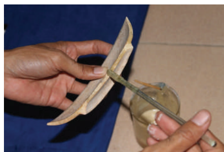
Gambar 4. Proses penyambungan dengan animal glue .
