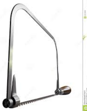
Gambar 1.24. Gergaji sekrol bentangan plat baja
