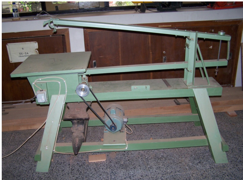
Gambar 1.28. Mesin sekrol dari kayu
