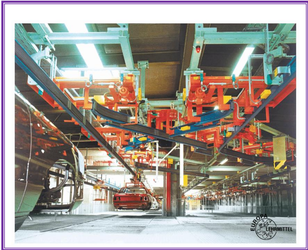
Gambar 4.1 Deteksi Posisi sistem conveyor-overhead dengan sensor
