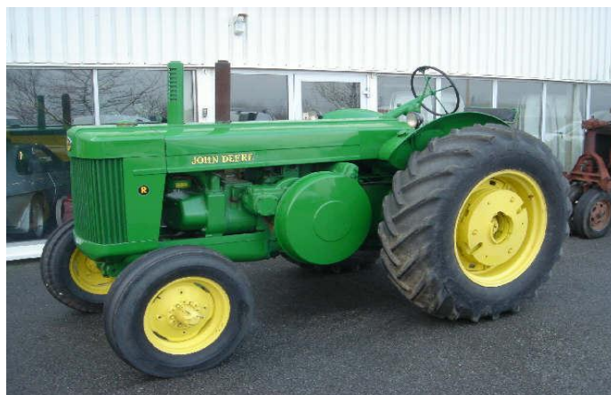
Gambar 4: Contoh bentuk traktor dengan ban karet
