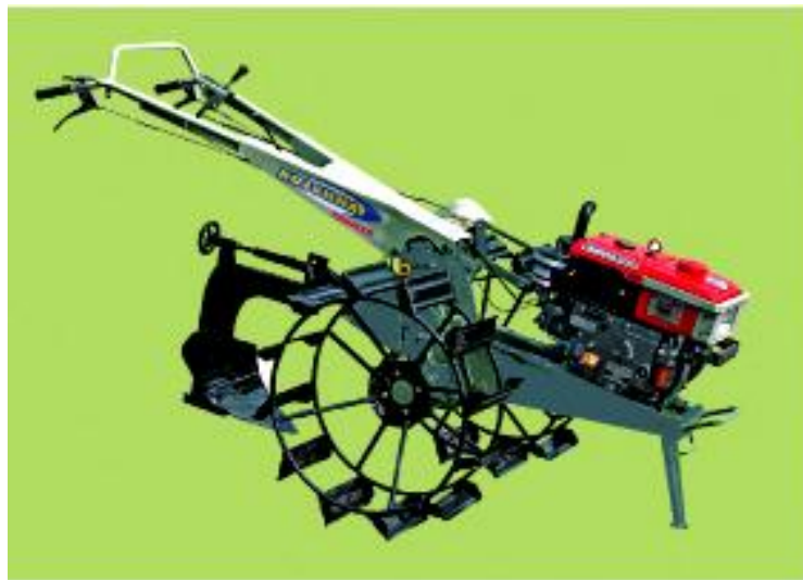
Gambar 34: Traktor roda dua dengan roda sangkar
