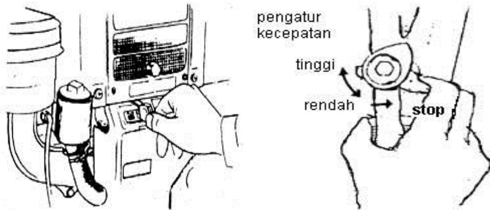
Gambar 51: Tuas regulator motor penggerak dan tuas gas.
