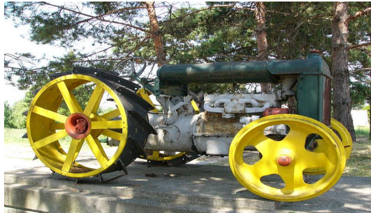
Gambar 3: Contoh bentuk traktor tanpa kerangka landasan
