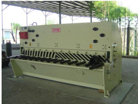
Gambar 14.9. Mesin guillotine dengan tenaga motor
