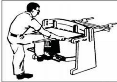
Gambar 14.8. Mesin guillotine dengan tenaga orang
