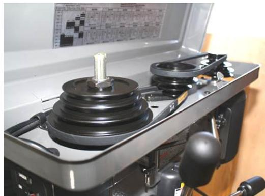
Gambar 12.6 Transmisi bor 12 tingkat kecepatan
