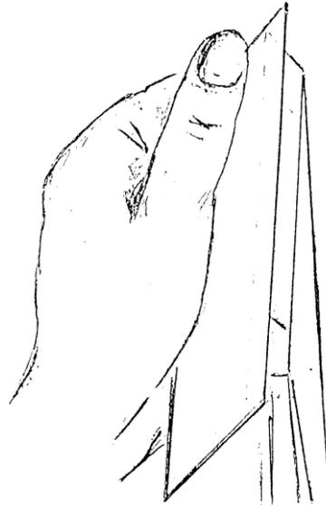
Gambar 17.3. Cara memegang benda kerja pada landasan penekuk lurus
