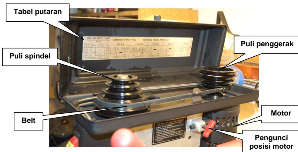
Gambar 12.5 Transmisi bor lima tingkat
