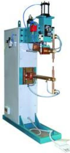
Gambar 14.44. Mesin las titik
