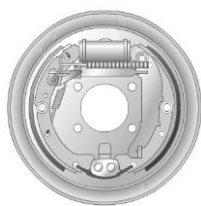
Gambar 32. Self-energizing effect pada sepatu rem primer .
