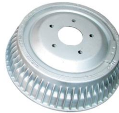
Gambar 7. Sistem pendingin tromol.
