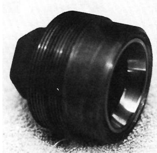
Gambar 196. Tutup penyetel bantalan dengan races masih terpasang.
