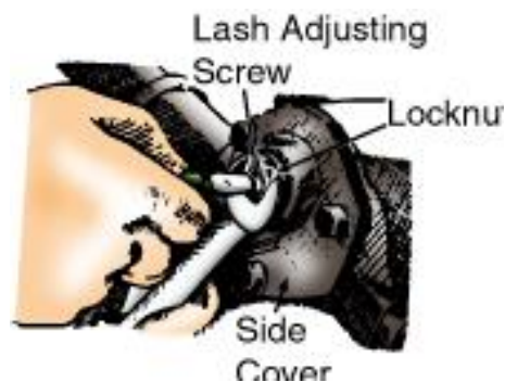
Gambar 178. Cara menyetel back-lash.
