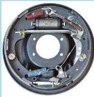
Gambar 37. Rem duo servo.
