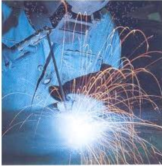
Gambar Penyalaan busur listrik pada las SMAW
