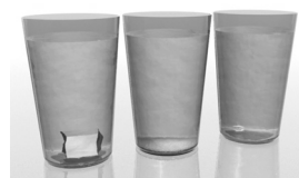
Gambar 4.20 Laju reaksi yang berbeda pada pelarutan gula dengan luas permukaan berbeda
