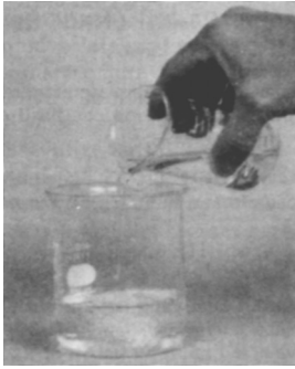
Gambar 7.5 HCl yang ditambahkan pada kalsium karbonat menghasilkan gas CO 2 yang terlihat
