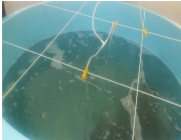
Gambar 29. Pemasangan Aerasi pada Bak Pembenihan Ikan
