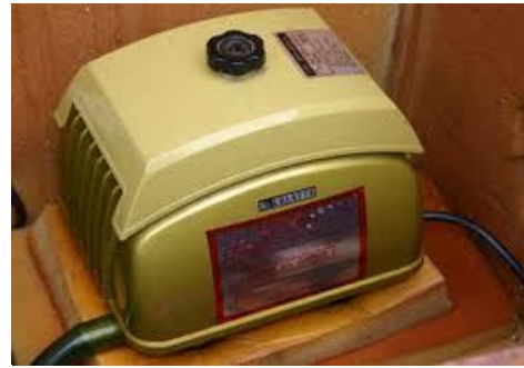
Gambar 32. Blower / Aerator untuk Pembenihan Ikan
