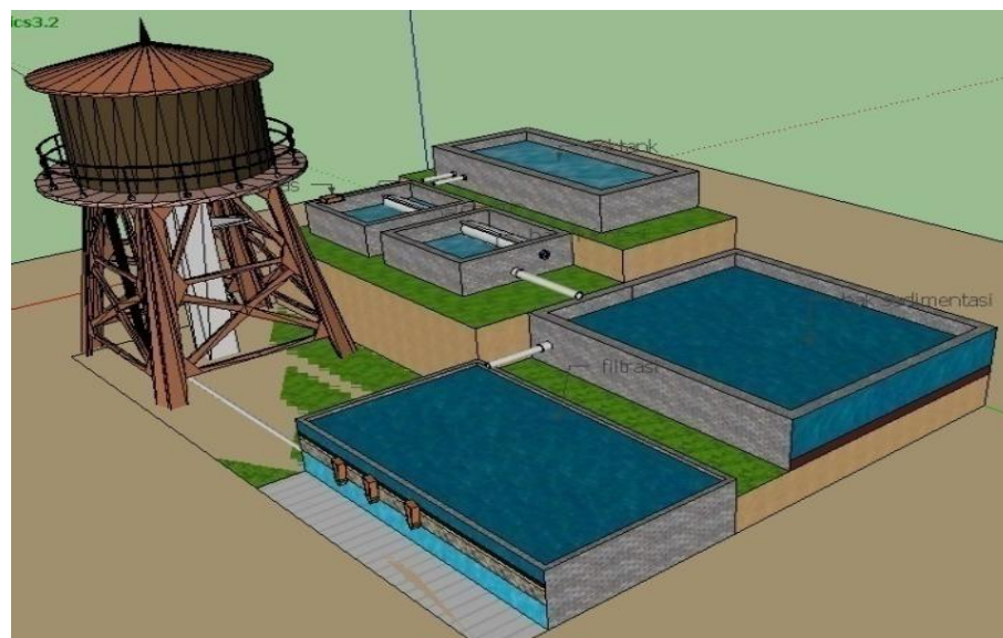
Gambar 34. Instalasi Air Untuk Pembenihan Ikan
