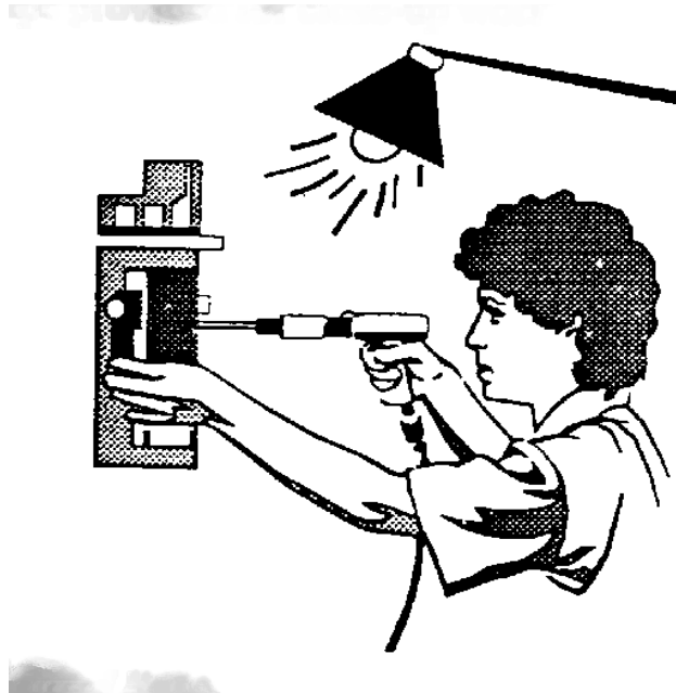
Gambar 1-5. Penggunaan lampu untuk pekerjaan di tempat tertutup.
