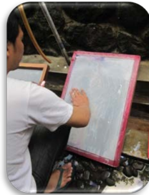
Gambar. 3.5 Penghapusan gambar pada screen (Sumber: Koleksi foto pribadi, 2013)
