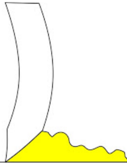
Gambar 2.49. Raket melengkung karena terlalu ditekan (Foto. http://kaospolosAndalas.com )
