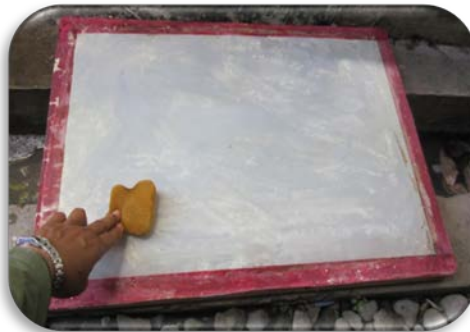
Gambar 1.21. Mengolesi screen dengan kapurit (Sumber: Koleksi foto pribadi, 2013)
