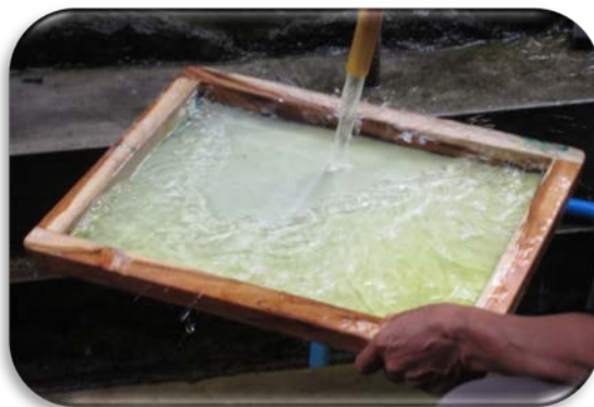
Gambar: 3.32. Membasahi bagian dalam dan luar screen (Sumber: Koleksi foto sendiri, 2009)
