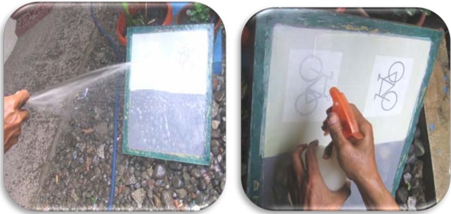
Gambar: 3.20. Penyemprotan untuk menimbulkan gambar pada screen (Sumber: Koleksi foto sendiri, 2009)
