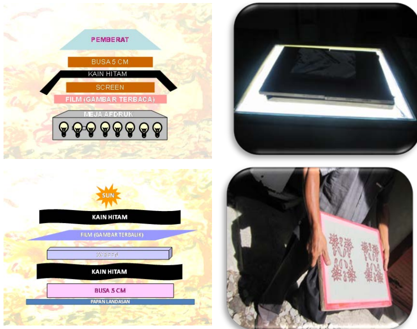
Gambar.3.3. Poses pembuatan fim negatif (Sumber: Koleksi pribadi, 2013)
