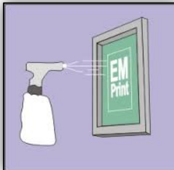
Gambar 2.38. Penggunaan hand spreyer pada screen Setelah afdruk (Foto. Google com)
