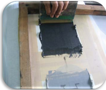
Gambar: 3.27. Penyablonan warna ke dua (Sumber: Koleksi foto sendiri, 2009)
