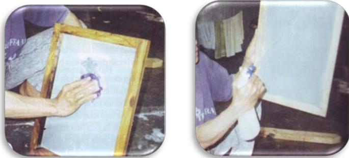
Gambar 1.4. Penghapusan Gambar Pada Screen (Sumber: Sablon Pada Berbagai Jenis Bahan)
