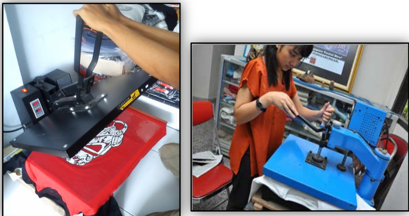
Gambar 2.53. Cara menggunakan alat press (Foto. Koleksi pribadi)
