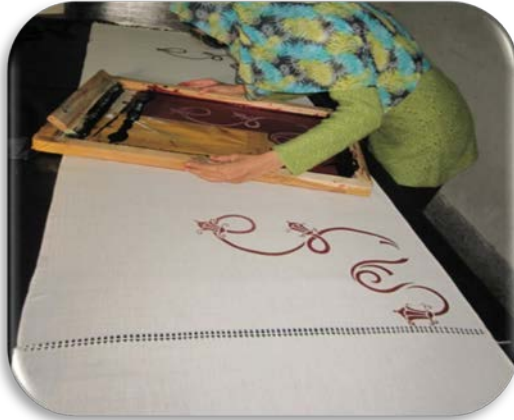
Gambar 1.17. Mengangkat screen setelah penyablonan (Sumber: Koleksi Foto Pribadi, 2013)
