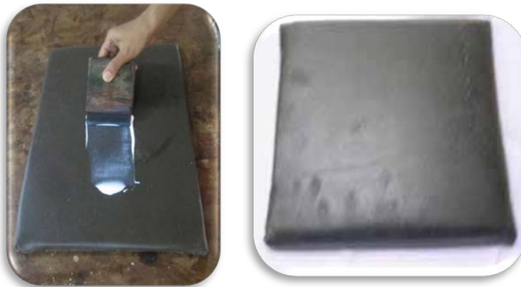
Gambar: 3.24. Papan landasan sablon kaos (Sumber: Koleksi foto sendiri, 2009)
