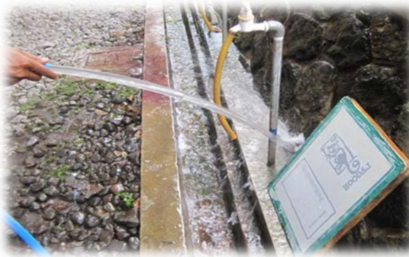
Gambar 1.11. Penyemprotan Screen setelah afdruk (Sumber: Koleksi Foto Pribadi, 2013)
