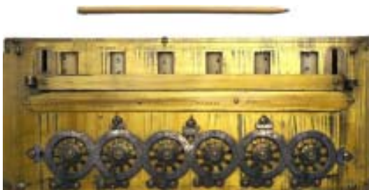
Gambar 1.21 Mesin hitung mekanik buatan Blaise Pascal pada tahun 1642
