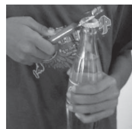
Membuka tutup botol menggunakan pengungkit
