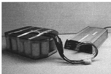
Gambar 2.14 Susunan seri 20 buah baterai NiMH yang memiliki potensial sel 24 V
