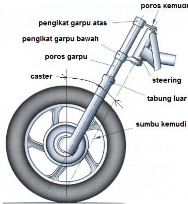
Gambar : Suspensi yang terkoneksi dengan steering
