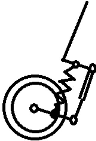
Gambar 2. Konstruksi suspensi leading link
