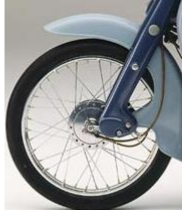
Gambar 2. Konstruksi suspensi leading link
