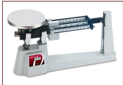
Gambar 2.9a. Timbangan Mekanik (Neraca Ohaus) Sumber: http://id.wikipedia.org/wiki/Timbangan
