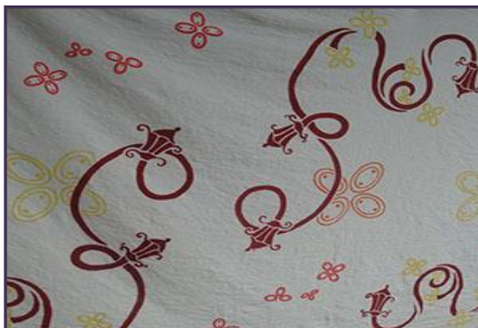
Gambar 1.6e Pewarnaan dengan cara printing/screen printing
