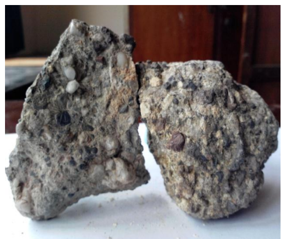
Gambar 1..56. Batuan sedimen Klastik Golongan Detritus kasar : Batu Konglomerat Perhatikan fragmen batuannya yang relative membulat (rounded)
