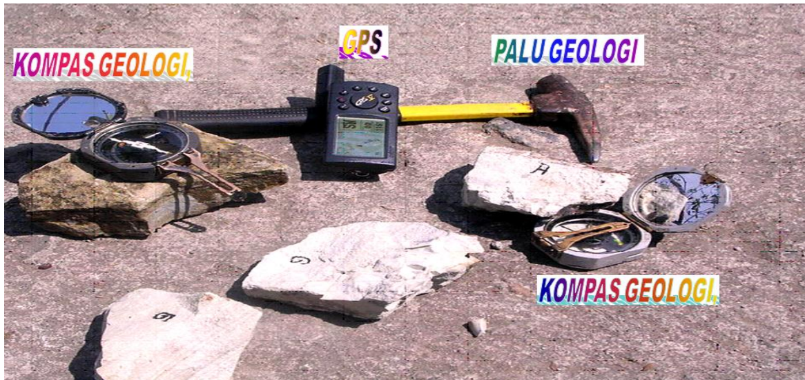
Gambar 1.99. peralatan geologi lapangan : Kompas, palu, GPS
