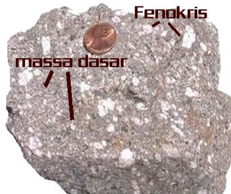
Batuan dengan Tekstur Inequigranular Porfiritik
