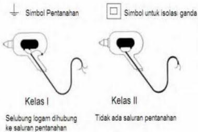
Gambar 1.16. Contoh klasifikasi pengamanan alat portabel
