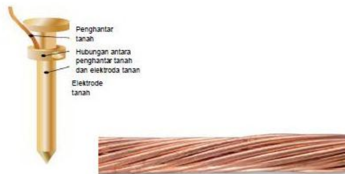
Gambar 19. Kawat Penghantar Pentanahan
