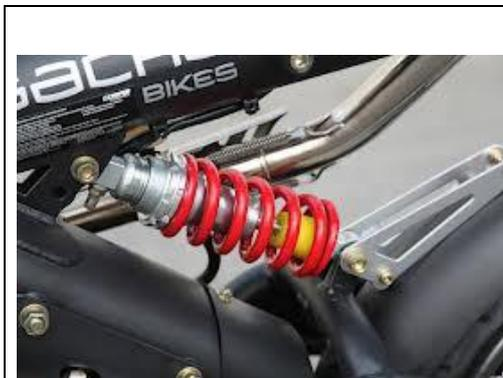
Jenis suspensi ini mempunyai satu peredam kejut yang mendukung bagian belakang *frame body* dan bagian *swing arm*. Suspensi ini memiliki konstruksi yang rumit, tetapi lebih stabil dibanding jenis *double suspension*. Banyak digunakan pada sepeda motor *modern* untuk keperluan *sport*.
