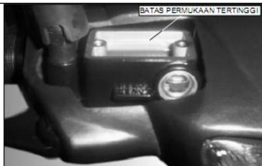
Isilah kotak minyak rem dengan minyak rem DOT 4 sampai tanda batas permukaan tertinggi.
