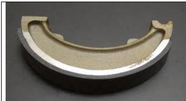
Kampas-kampas rem ini disatukan [dipasangkan] pada sepatu rem dengan perekat (*adhesive*) yang dikeringkan dengan panas. Selama proses perekatan, bagian belakang kampas rem dan meja dari permukaan sepatu rem dilapisi dengan suatu perekat khusus.
