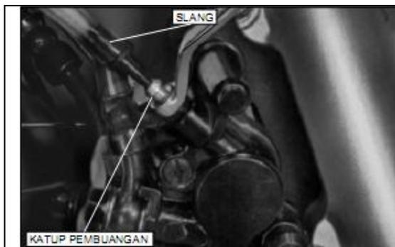
Tutup katup pembuangan dan mainkan handel rem. Jika terasa lunak, buang lagi udara palsu. Jika alat brake bleeder tidak tersedia, lakukan pembuangan udara palsu dengan cara berikut: Naikkan tekanan sistem dengan handel rem sampai tidak ada lagi
