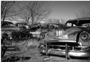
Gambar 2.16 Kerangka mobil yang berkarat akibat korosi melalui reaksi redoks
