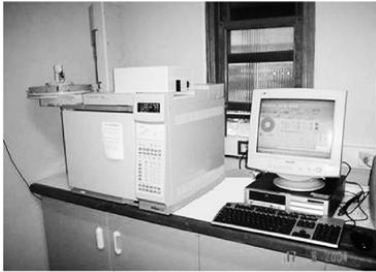
Gambar 3.5 Kromatografi gas merupakan alat untuk memisahkan senyawa dalam sampel, memerlukan gas Ar sebagai pembawa (carrier)
