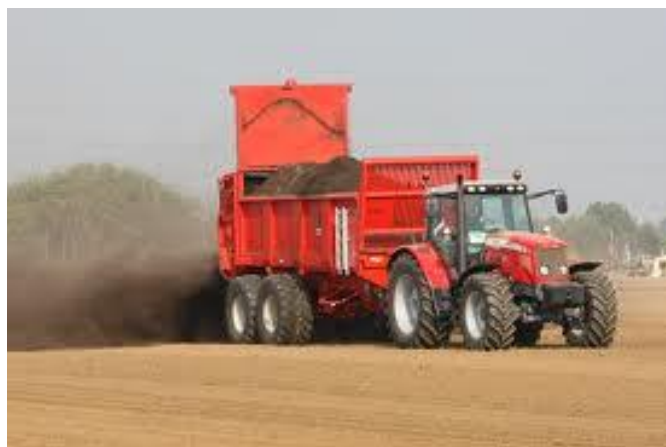
Gambar 61. Alat penyebar rabuk (pupuk kandang)
