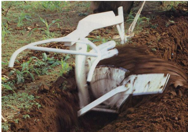
Gambar 33. Pengolahan tanah dengan bajak singkal
