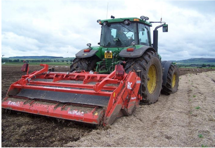
Gambar 49. Proses pengolahan tanah dengan bajak rotari
