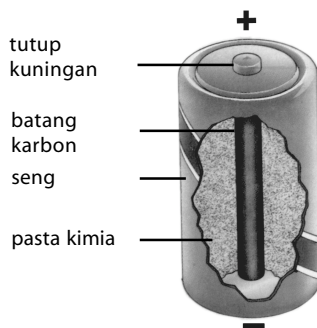
Gambar 8.20 Susunan dasar sebuah elemen kering.
