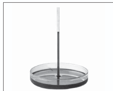
Gambar 3.5 Permukaan air pada pipa kapiler naik.
