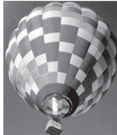
Gambar 3.11 Balon udara menggunakan prinsip pemuaian gas sehingga dapat terbang
