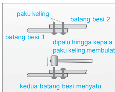
Gambar 3.13 Proses pengelingan untuk menyambung dua batang besi.
