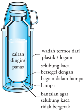
Gambar 8.6 Termos dibuat sedemikian rupa agar tidak terjadi pertukaran kalor antara lingkungan dengan bagian dalam termos.
