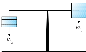
Gambar 5.4 Diagram gaya pada crane akibat beban di setiap lengannya.
