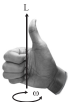
Gambar 5.7 Genggaman tangan kanan untuk menentukan arah momentum sudut. Keempat jari menunjukkan arah rotasi ( \omega ), sedangkan ibu jari menunjukkan arah momentum sudut.
