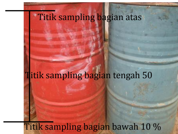
Gambar 2. Cara menentukan titik pengambilan contoh bahan cairan
