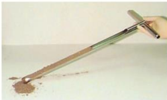
Gambar 21. Teknik Pengambilan Contoh Tanah dan Lumpur dengan Auger Drilling
