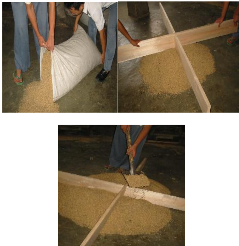
Gambar 12. Mengumpulkan Contoh, Membagi, dan Mencampur Contoh
