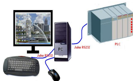
Gambar 4.11. Koneksi komputer ke PLC.
