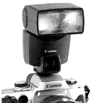
Gambar 3.3 Lampu kilat ( blitz ) yang dipakai pada foto analog mengandung gas xenon.
