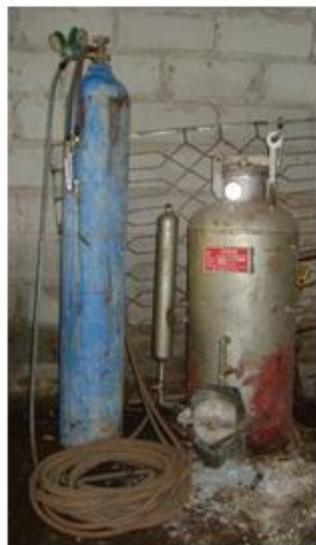
Gambar Tabung pembuat gas acetylene dari karbit
