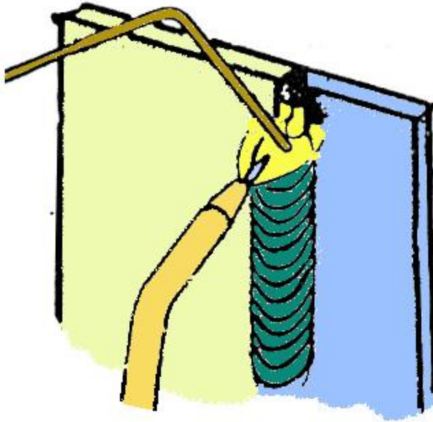
Gambar . 7.51. Mengakhiri jalur lasan pengelasan posisi vertikal
