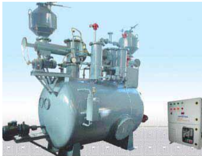
Gambar Generator untuk Memproduksi Gas Acetylene dalam Tabung
