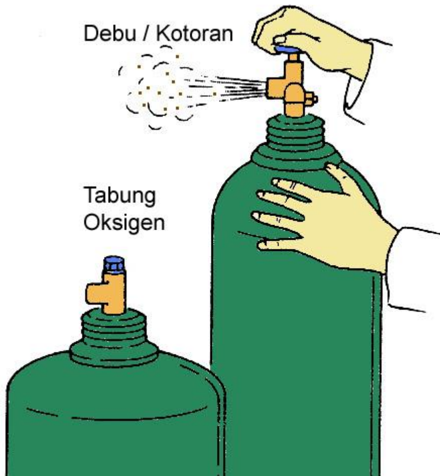
Gambar 7.15. Membuang kotoran di dalam katup tabung oksigen
