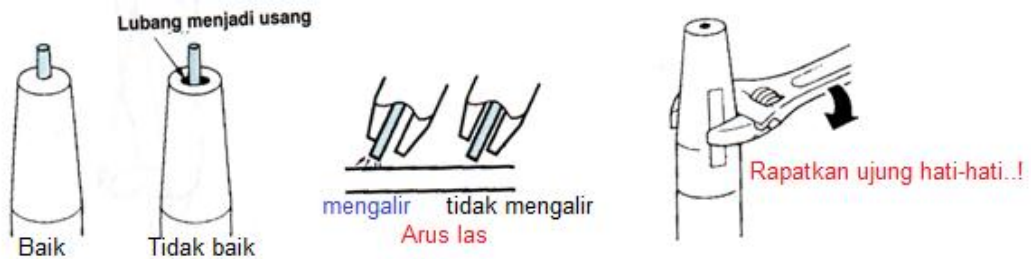
Gambar kondisi ujung kontak
