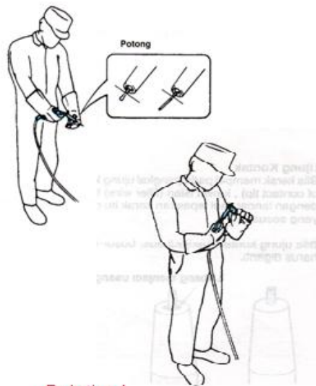
Gambar cara pemotongan kawat las CO2(MIG)
