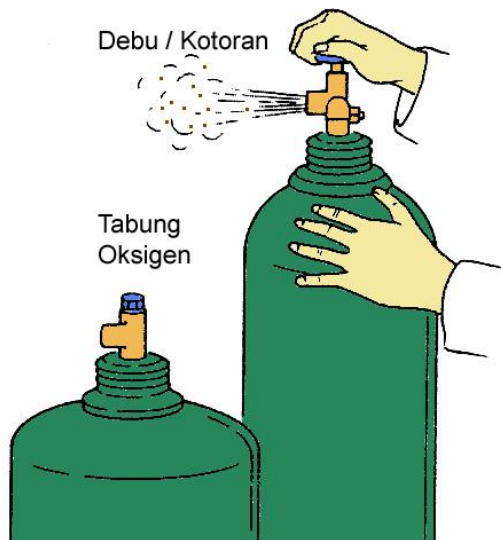
Gambar cara membuang kotoran pada tabung oxygen
