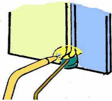
Gambar Memulai Pengelasan Posisi Vertikal
