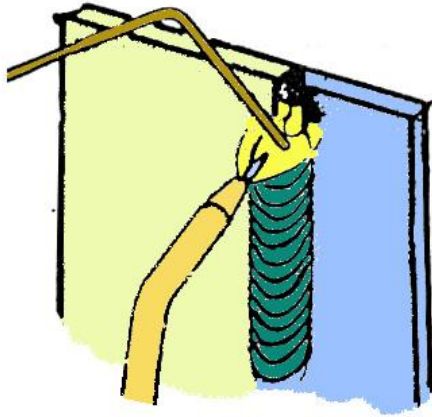
Gambar Mengakhiri jalur lasan pengelasan posisi vertikal
